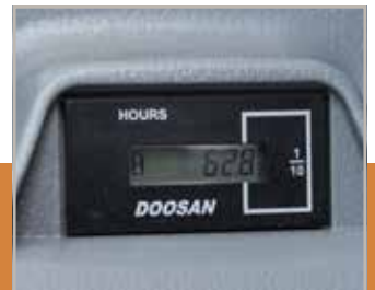
Betriebsstundenzähler (vom Boden aus ablesbar)
