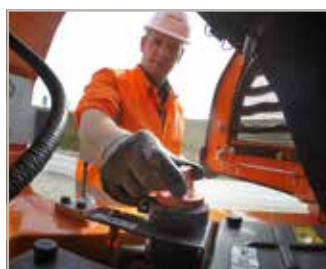
Sezionatore della batteria
