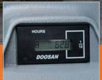
Betriebsstundenzähler (vom Boden aus ablesbar)
