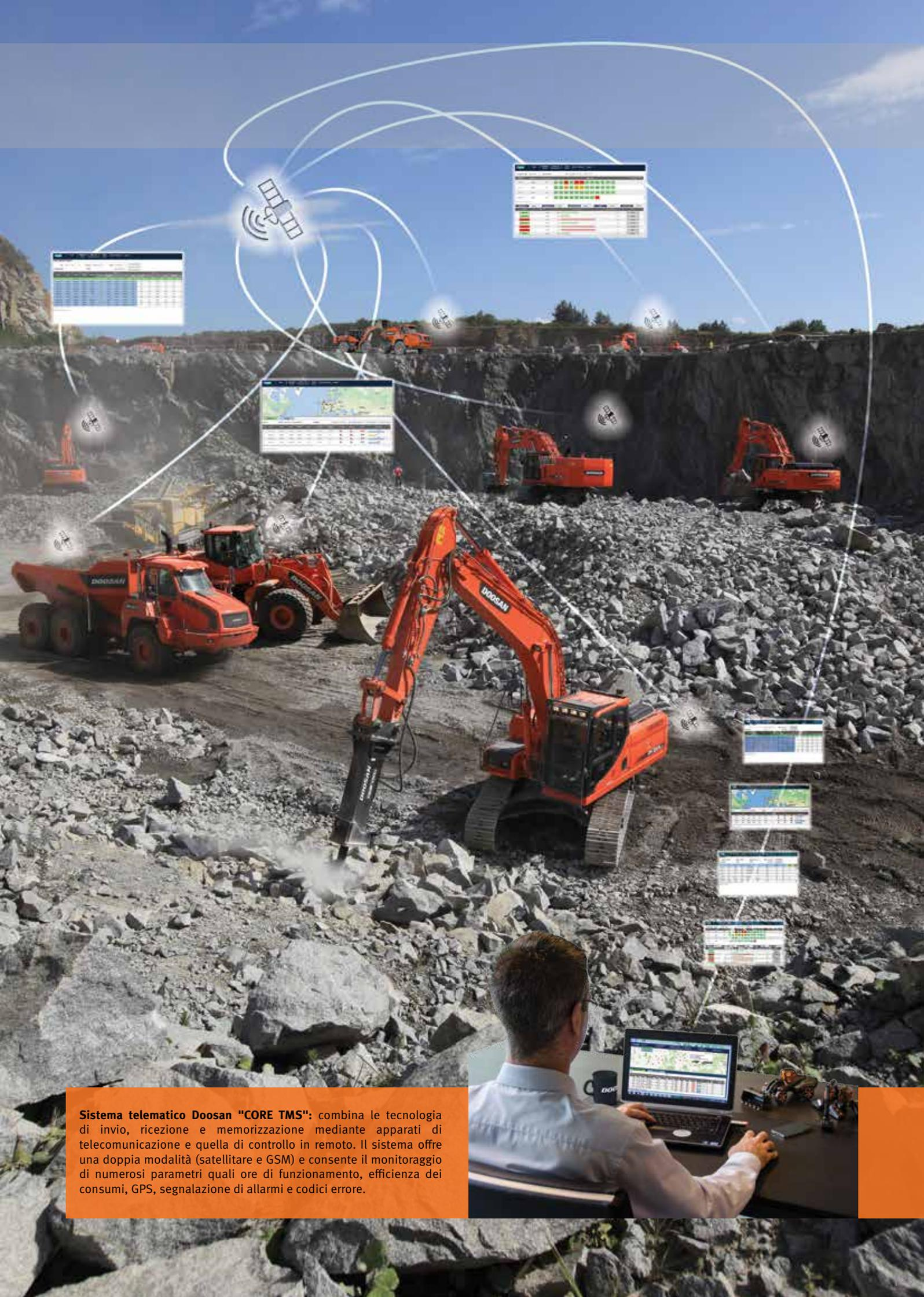
**Sistema telematico Doosan "CORE TMS":** combina le tecnologie di invio, ricezione e memorizzazione mediante apparati di telecomunicazione e quella di controllo in remoto. Il sistema offre una doppia modalità (satellitare e GSM) e consente il monitoraggio di numerosi parametri quali ore di funzionamento, efficienza dei consumi, GPS, segnalazione di allarmi e codici errore.
