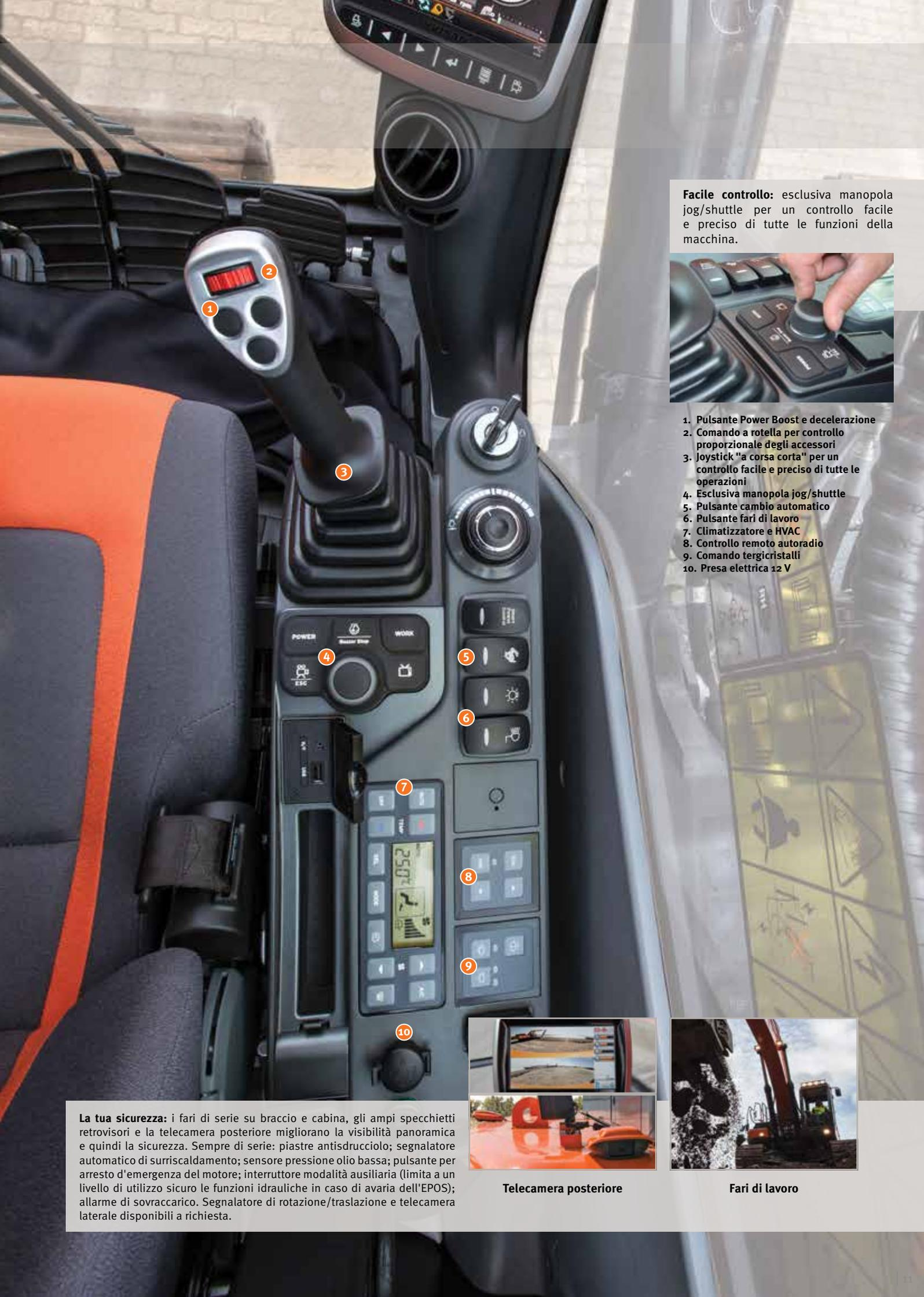
**Facile controllo:** esclusiva manopola jog/shuttle per un controllo facile e preciso di tutte le funzioni della macchina.
