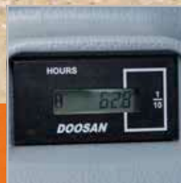
Betriebsstundenzähler (vom Boden aus ablesbar)
