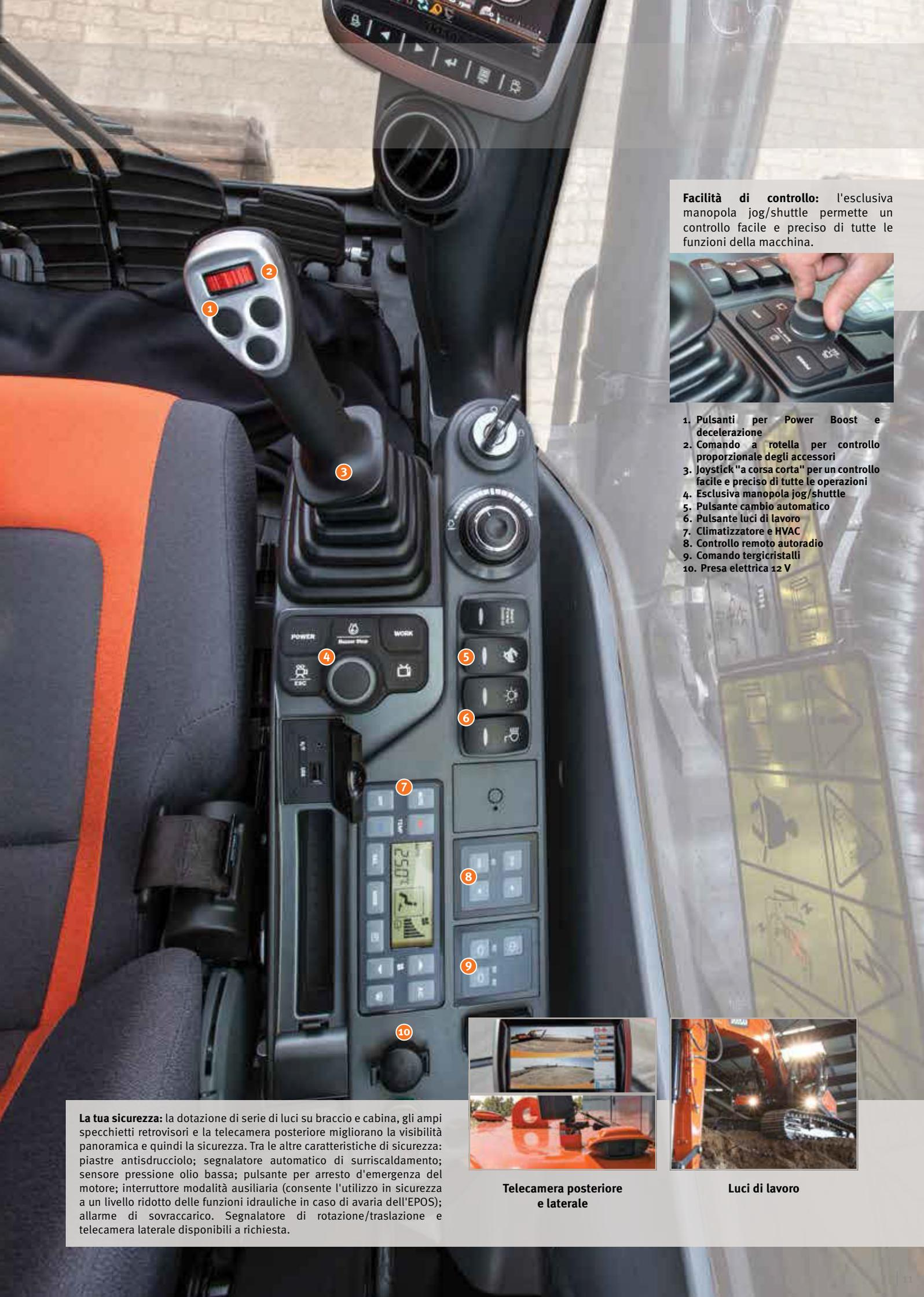
**Facilità di controllo:** l'esclusiva manopola jog/shuttle permette un controllo facile e preciso di tutte le funzioni della macchina.
