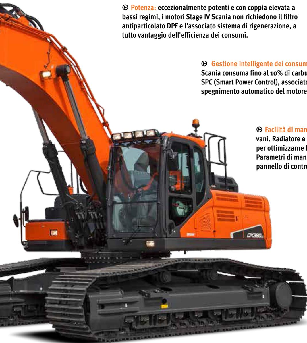
☉ **Sottocarro durevole:** rulli superiori in acciaio forgiato e a tempra profonda - rulli lubrificati a olio - ruota motrice trattata termicamente - catene a lunga durata lubrificate e lavorate a tempra profonda e con trattamento termico.
