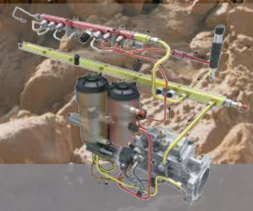
**Sistema di iniezione Common Rail XPI:** l'erogazione di carburante e la pressione di iniezione sono regolate indipendentemente dalla velocità del motore. Il sistema si adatta continuamente alle variazioni di regime, per assicurare il massimo rendimento da ogni singola goccia di gasolio.
