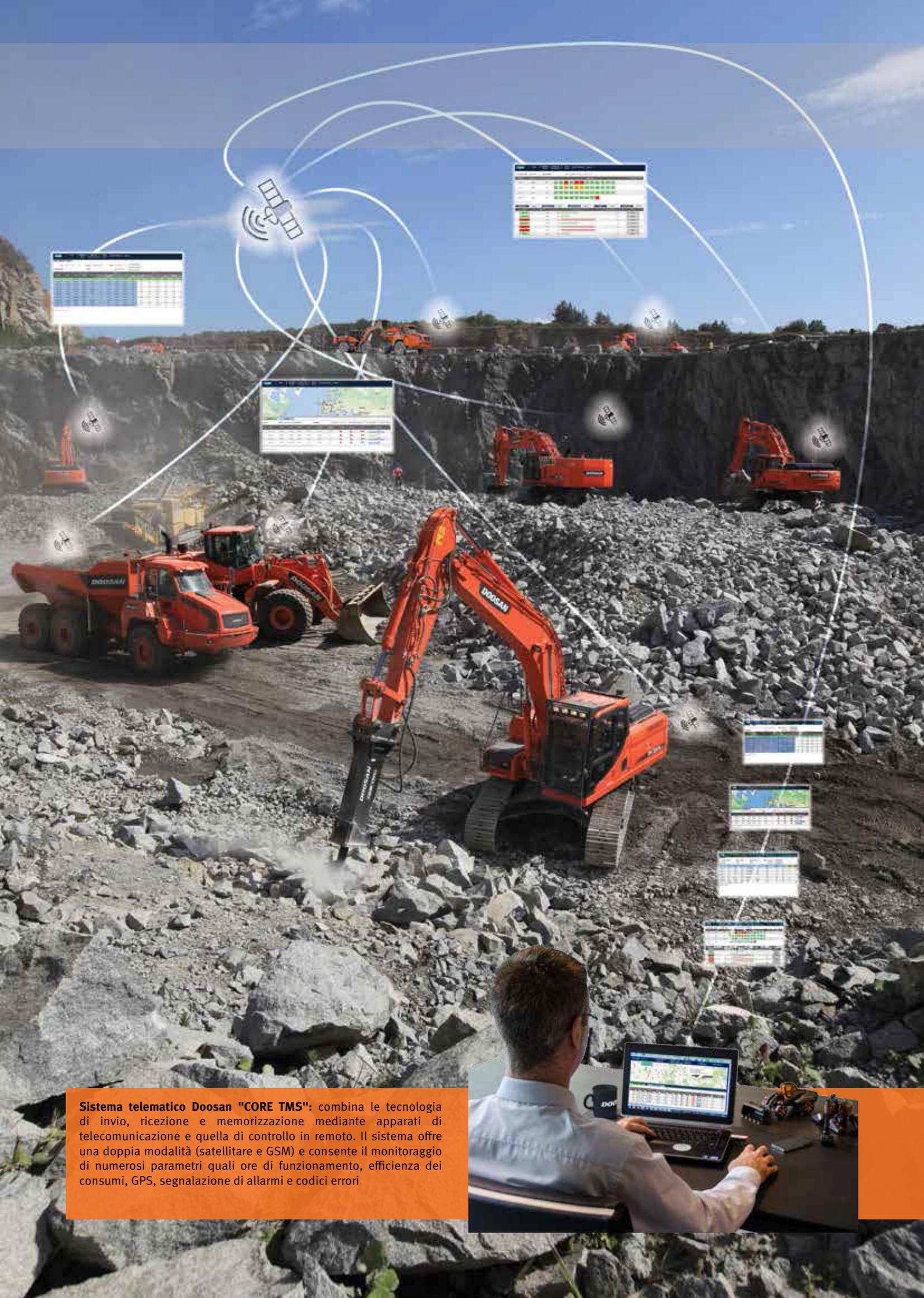
**Sistema telematico Doosan "CORE TMS":** combina le tecnologia di invio, ricezione e memorizzazione mediante apparati di telecomunicazione e quella di controllo in remoto. Il sistema offre una doppia modalità (satellitare e GSM) e consente il monitoraggio di numerosi parametri quali ore di funzionamento, efficienza dei consumi, GPS, segnalazione di allarmi e codici errori
